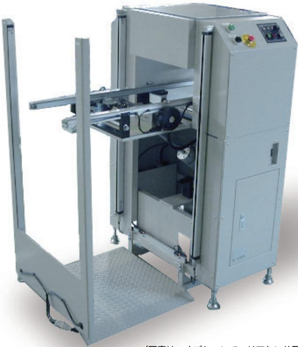
(写真は、オプションでエリアセンサ及びハンドル幅調整機構を追加したものです。)
